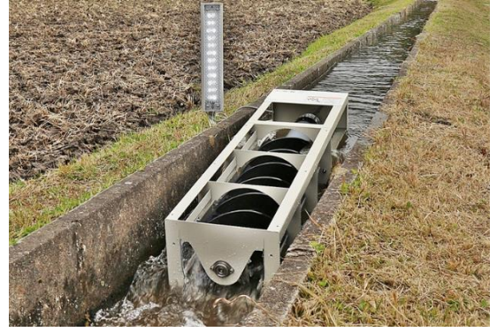
図 6-2-14 農業用水路でのマイクロ水力のイメージ 出典: https://suminoseisakusho.jp/index.html
